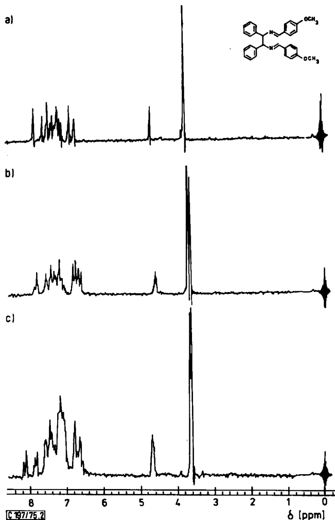
Abb. 2. ^1\text{H-NMR} -Spektren von meso -37: (a) bei Raumtemperatur; (b) nach 14 h bei 110-112^\circ\text{C} ; (c) nach 2 min bei 210^\circ\text{C} (in \text{CDCl}_3 , TMS als interner Standard)
